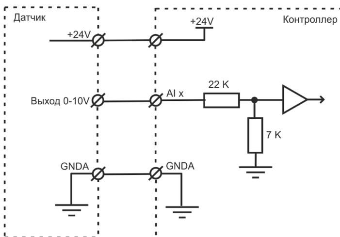
Рисунок 2.4 Универсальный аналоговый вход типа ADI20K10V (режим измерения напряжения)
