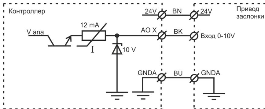
Рисунок 2.1 – Аналоговый выход напряжения типа AO10V
