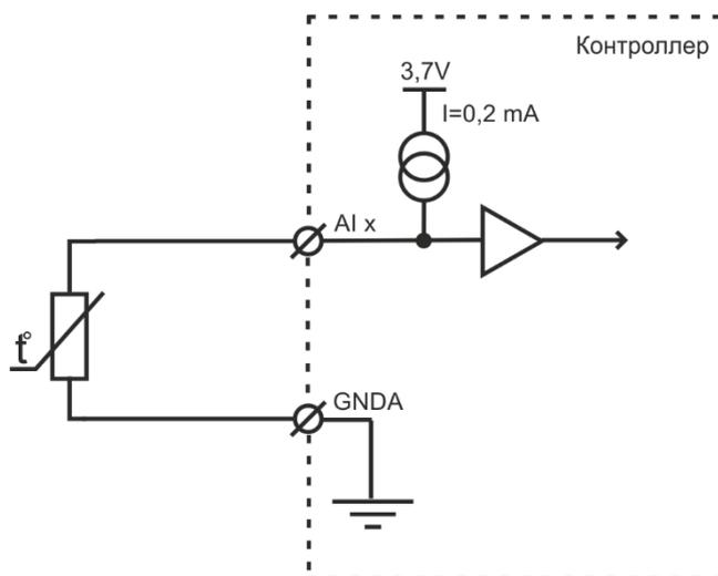
Рисунок 2.3 – Универсальный аналоговый вход типа ADI20K10V (режим измерения сопротивления или температуры)
