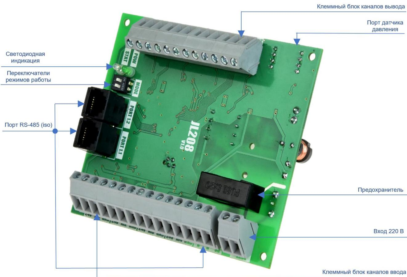
Рисунок 1.3 – Расположение элементов на плате контроллера
