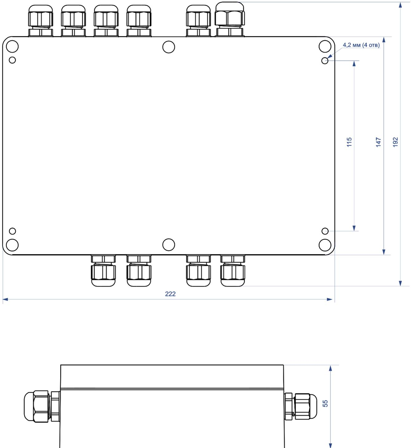
Рисунок 1.2 - Габаритные и установочные размеры
