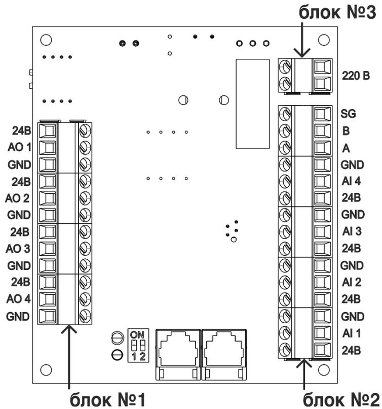
Рисунок 1.4 – Расположение клеммных блоков на плате контроллера
