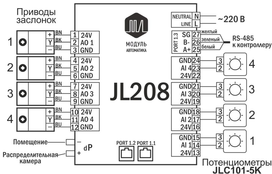
Рисунок 3.1 – Типовая схема включения
