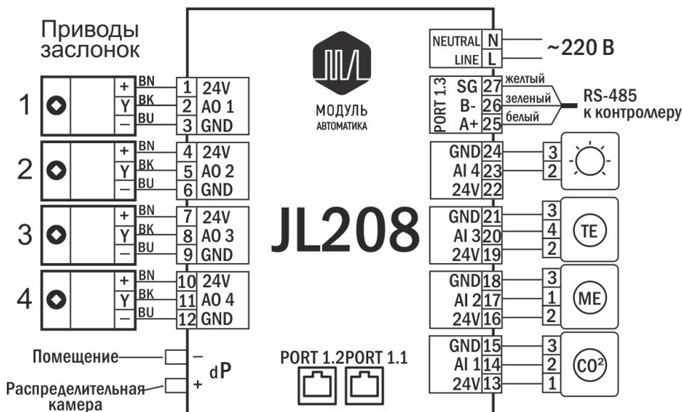
Рисунок 3.2 – Схема подключения датчиков
